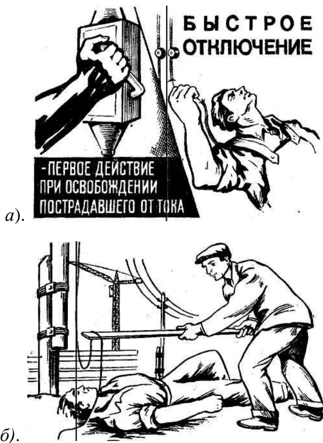
Рисунок 1 – Освобождение пострадавшего от действия электротока: а) – путем отключения электроустановки; б) – отбрасыванием провода доской
